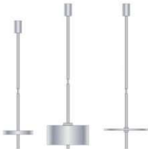
Рисунок 11. Діскові шпинделі, які використовуються в ротаційних віскозиметрах.
